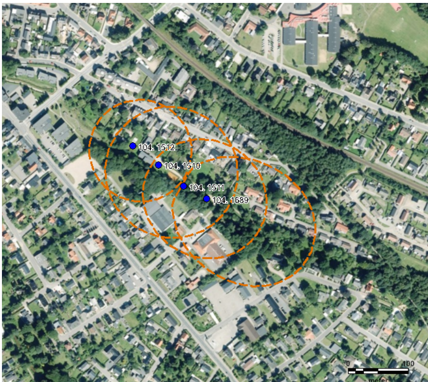
Figur 2. BNBO ved de to kildepladser (Den Gyldne Middelvej øverst og Bilchersvej nederst).
